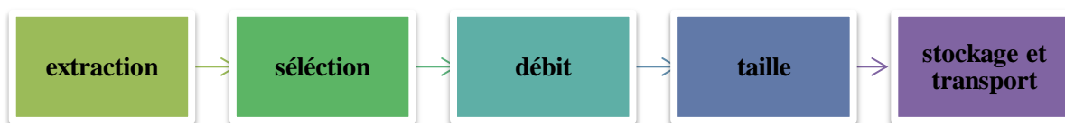
Figure II.5: les phases de fabrication de pierre source : auteurs
