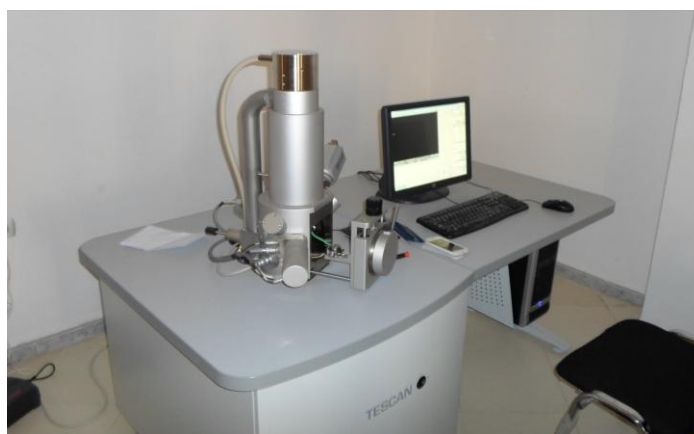
Figure 5.5 : Microscope électronique à balayage (TESCAN Easy Probe)
