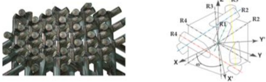
Figure 4.8. Un tissu composite « 4D » carbone/carbone : (a) vue des renforts, (b) schématisation et repère d'orthotropie [8].
