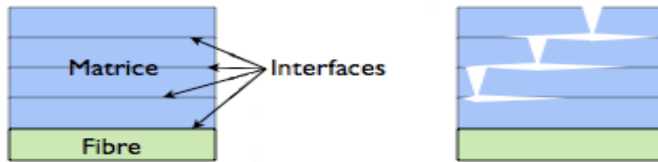
Figure 2.12. (a) Schématisation d'une matrice multicouche ; (b) effet protecteur des interfaces : les fissures sont déviées et leur progression vers les fibres est donc ralentie [2,4]
