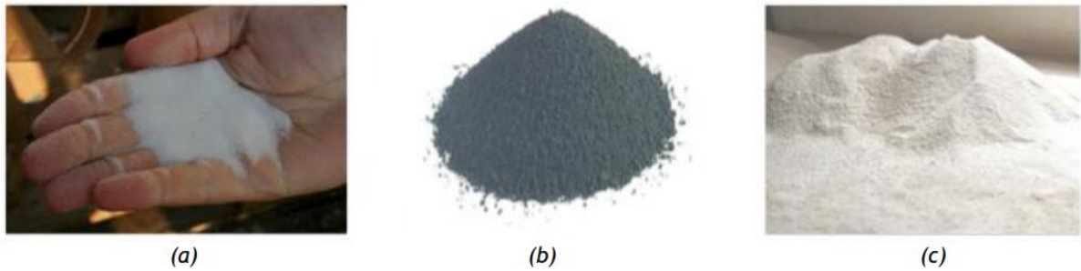
Figure 2.10. Exemples de charges utilisées dans les CMO : (a) Microbilles de verre, (b) Noir de carbone, (c) Silice.
