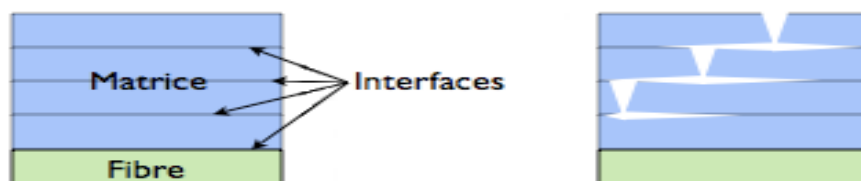
Figure 3.18: (a) Schématisation d'une matrice multicouche ; (b) effet protecteur des interfaces : les fissures sont déviées et leur progression vers les fibres est donc ralentie.
