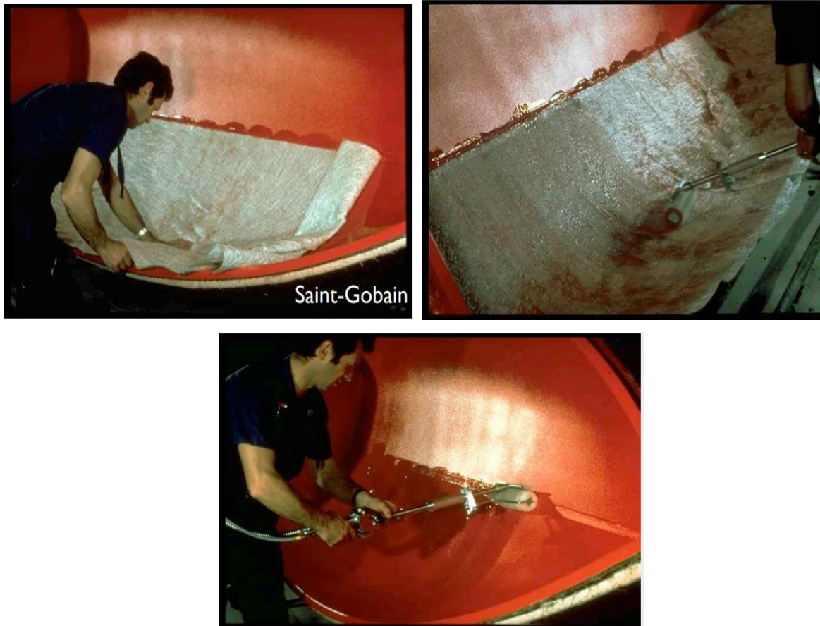
Figure.3.2 Les opérations du moulage au contact [2]
