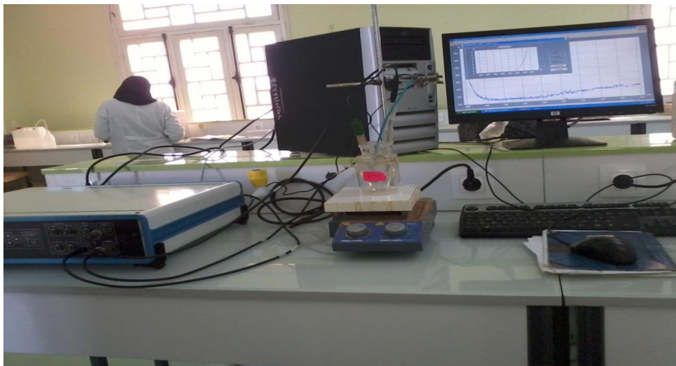
Figure II.7: Dispositif Expérimental de la technique Potentiostatique.
