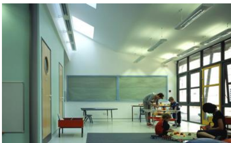
Figure 17: Exemple d'éclairage naturel contrôlé avec éclairage d'appoint artificiel, Netley School Autistic Resource Base Source : http://www.archdaily.com
