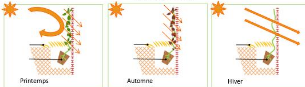
Figure 42 : Schéma en coupe d'une persienne avec plante grimpante Source : archdaily.com
