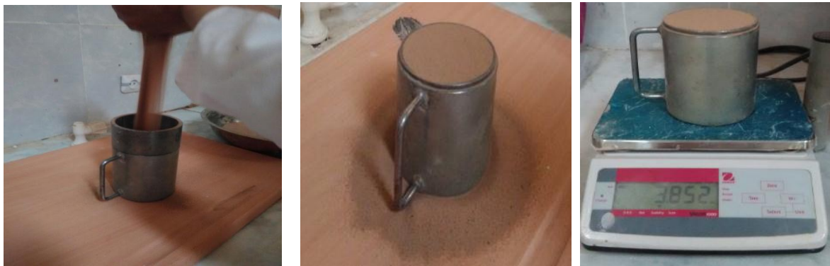
Figure 3. 8: L'essai de mesure de la masse volumique apparente du sable utilisé.
