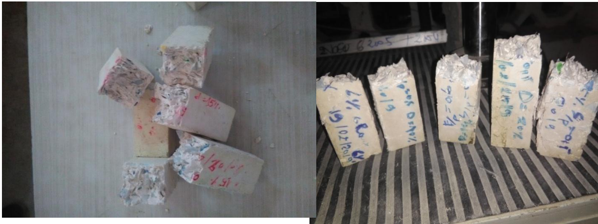
Figure A.3.2. Écrasement des éprouvettes pour les différentes compositions MDP et PDP.
