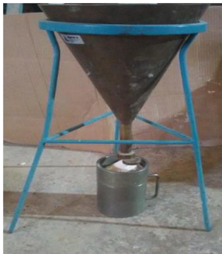
Figure 3. 3: Dispositif pour l'essai de la masse volumique apparente.
