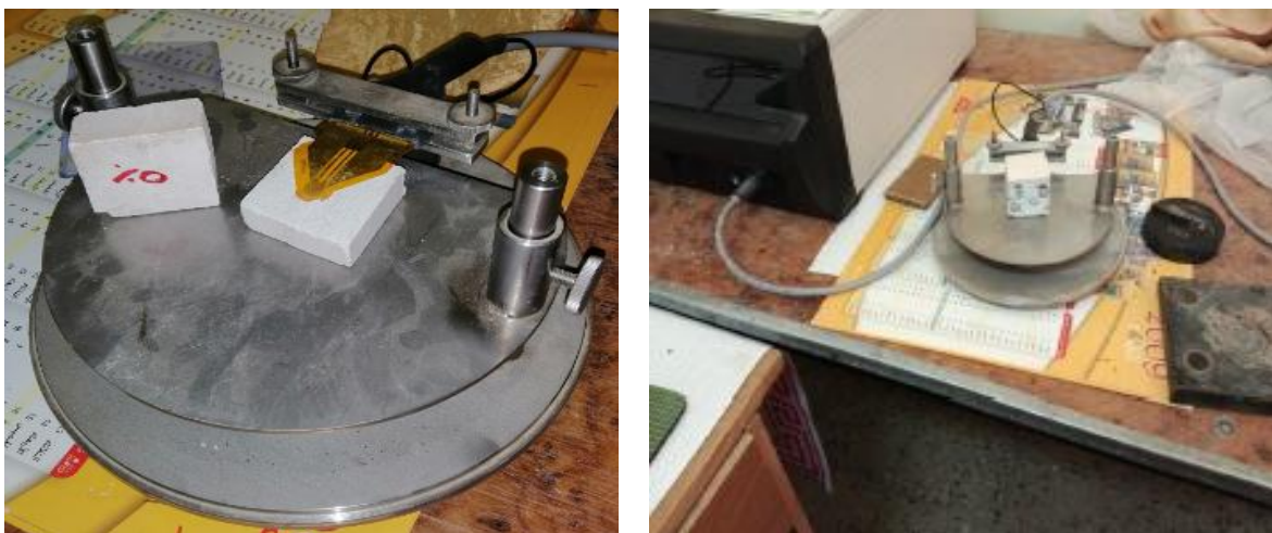
Figure 3. 20: Dispositif de serrage, sonde, éprouvette.
