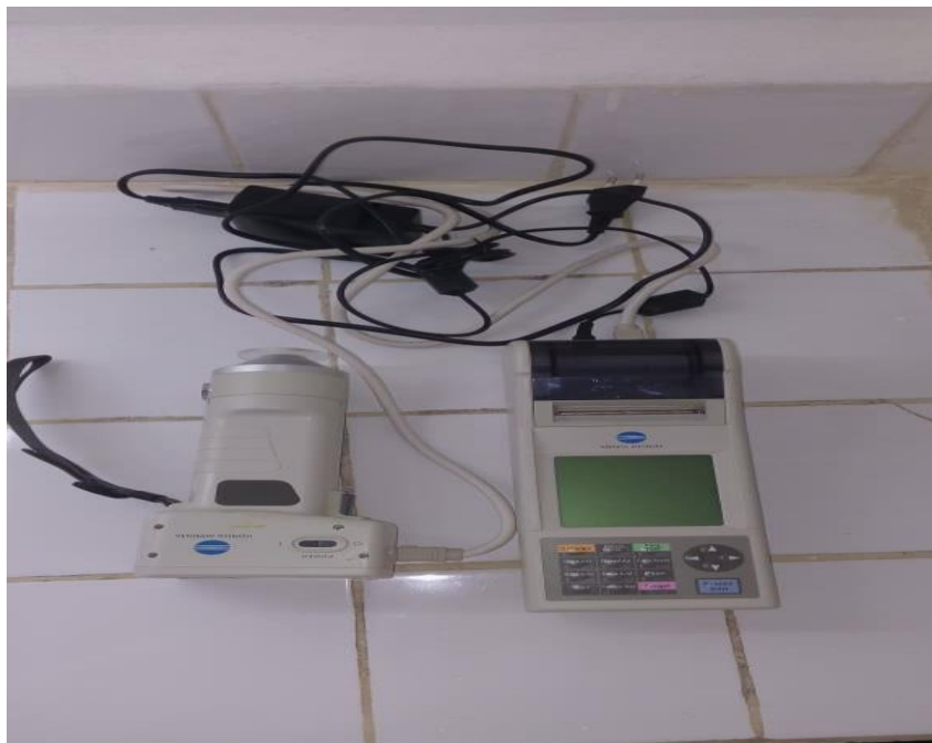
Figure 02: l'appareille de mesure de l'indice de jaune d'un couscous sec (source : originale)
