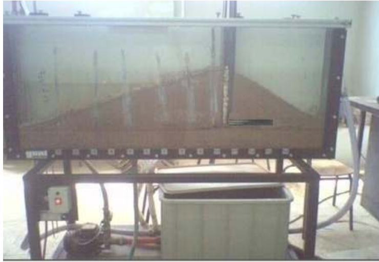
Fig. (IV.14) : Barrage en terre homogène avec un drain vertical sur une base perméable (Modèle02).
