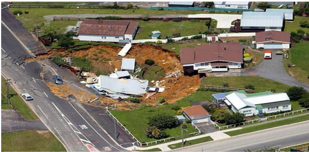
الشكل 1-9: تأثير التربة الإنهيارية علي الطرق والمنشآت.
