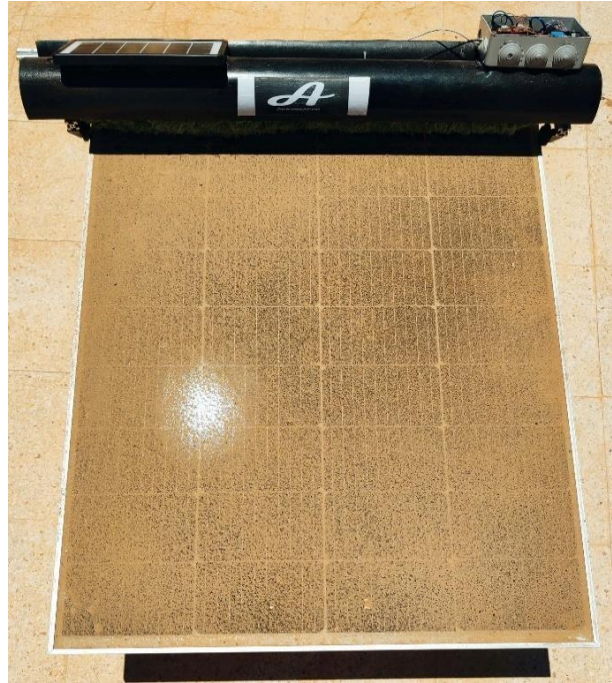
Figure III.18 Panneau solaire avant nettoyage – Recouvert d'une couche visible de poussière.
