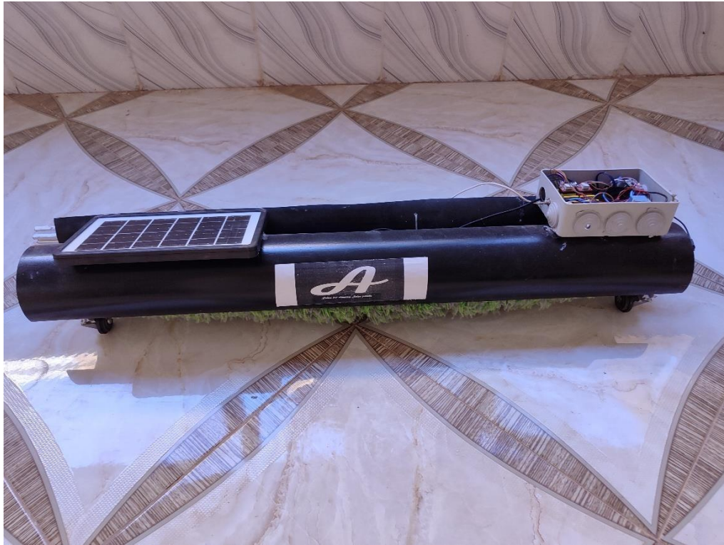
Figure III.17 Forme finale du robot – Vue latérale montrant le système de nettoyage mécanique.
