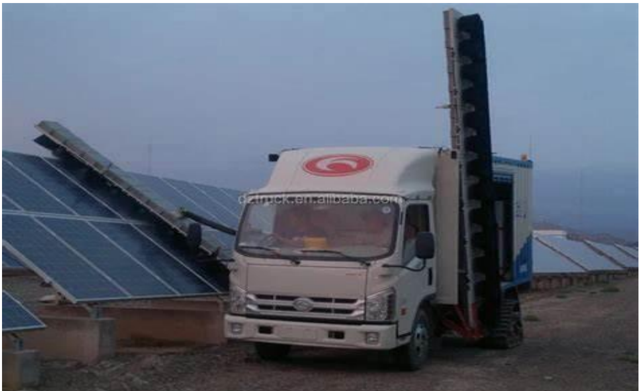
Figure II.7 Un camion avec une flèche pour nettoyer les panneaux solaires photovoltaïque
