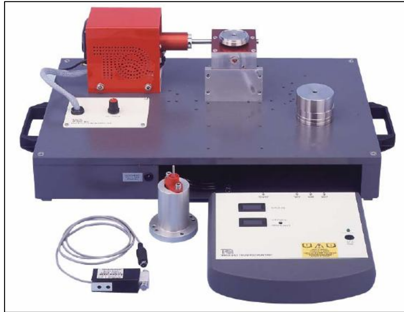
Figure 3.7 : Tribomètre utilisé pour les essais d'usure abrasive « pion-disque ».
