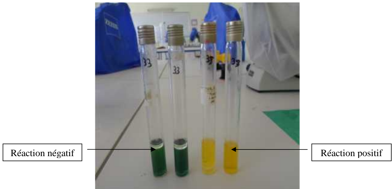
Figure n°20: Resultat de test High et Leifson(Original,2014)
