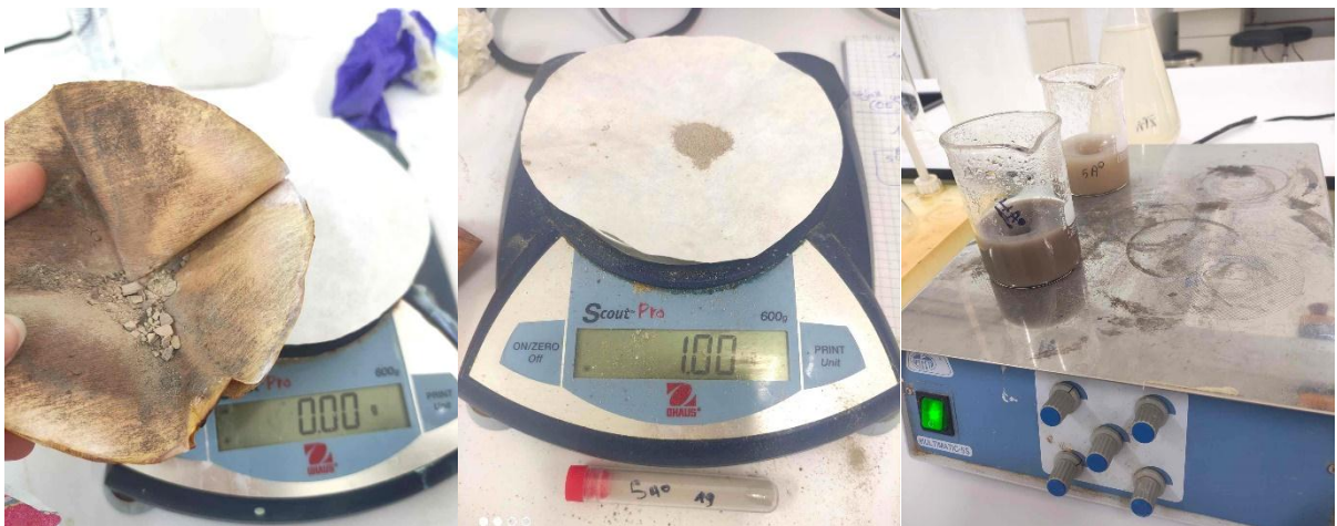
Figure 30 : Préparation de la suspension aqueuse de Ag-zéolite (photo personnel .2024)
