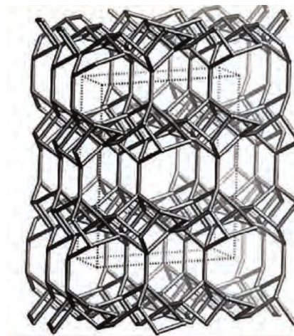
Figure14 : Modèle-cadre pour la clinoptilolite (HEU) (Baerlocher et al., 2001).
