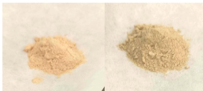
Figure 24 : photo deux types de zéolithe poudre ZSM-5 4A° et FAU 5A° (photo personnel .2024)
