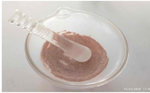
Figure 20 : Broyage de zéolithe Granule ( photo personnel . 2024)
