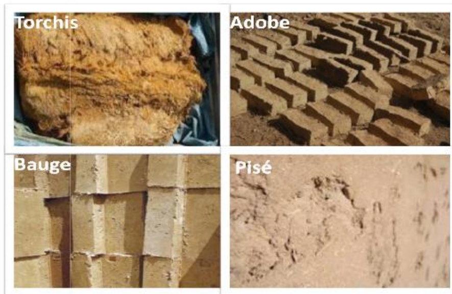
Figure I.7 : Techniques de construction en terre crue
