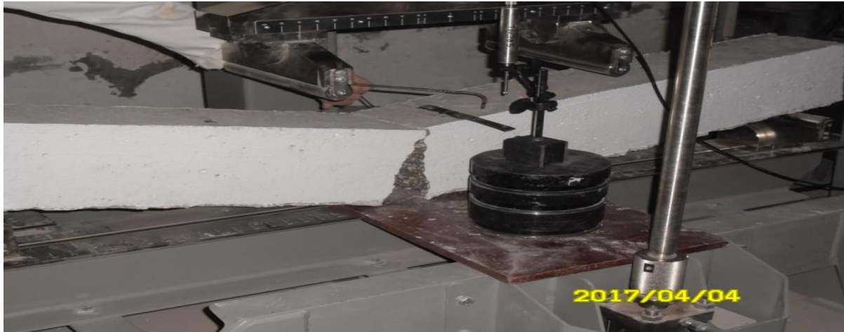
Figure III.22 La rupture de la poutre en béton non armé (essai expérimental)
