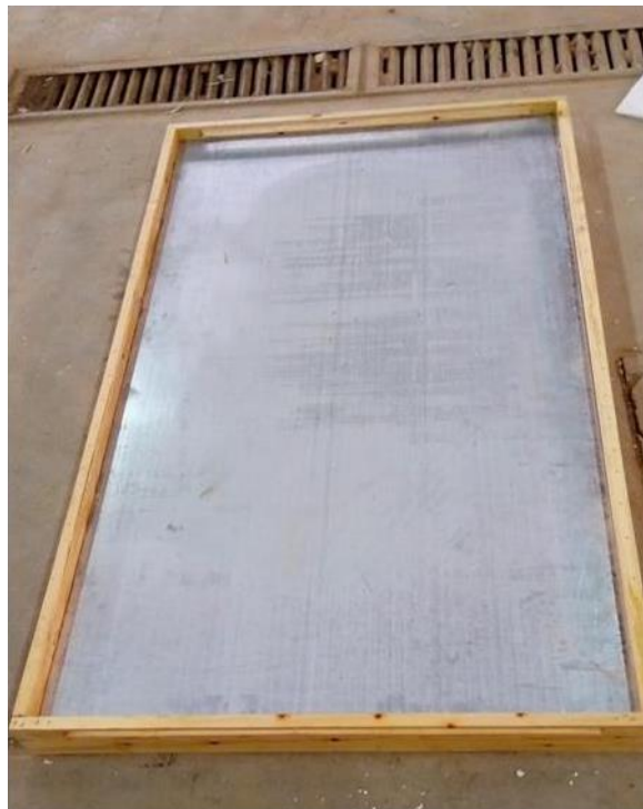
Figure 2.9 : Le cadre inferieur du banc d'essai après l'ajout d'une plaque de polystyrène (40 mm) + plaque MDF ( e = 2.5 mm) + Tôle galvanisée ( e = 1.5 mm).
