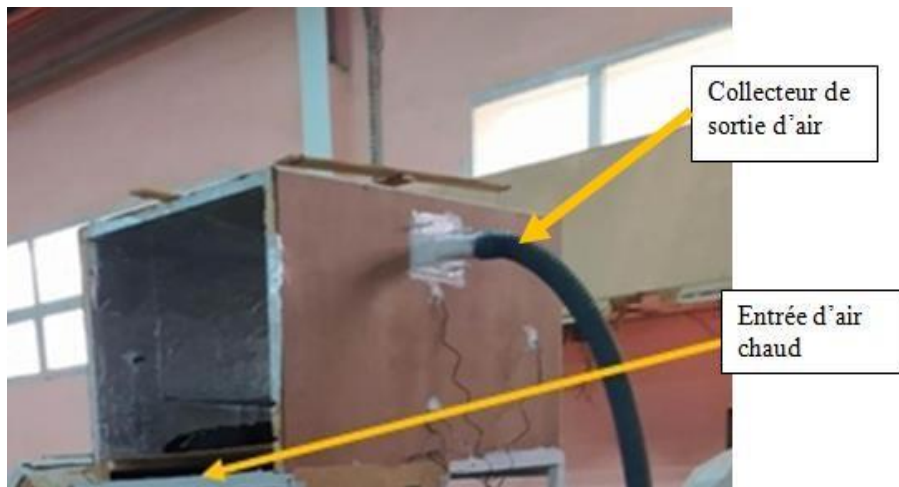
Figure 2.5 : Chambre à sécher.
