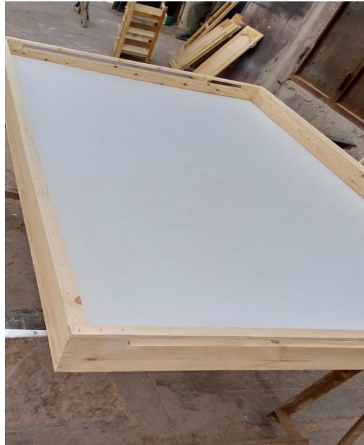
Figure 2.8 : L'ajout de la plaque de polystyrène au dessus du contre plaquée.
