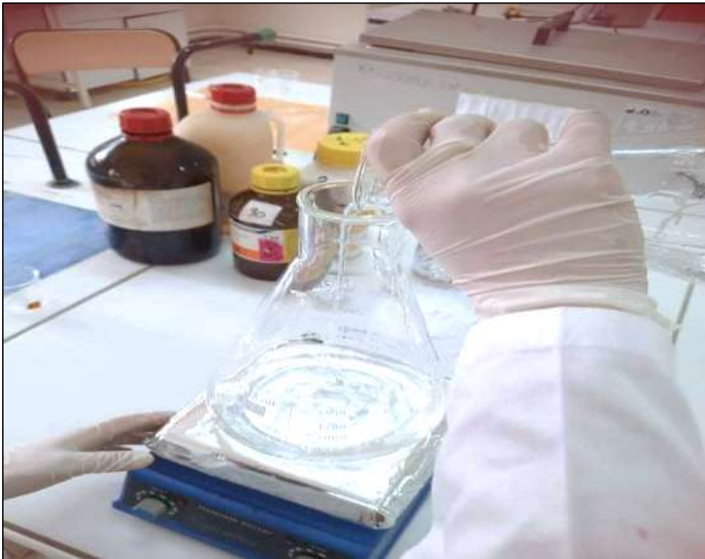
● Préparation du réactif de Zambelli menée pour les analyses chimiques de l'eau (originale, 2022).
