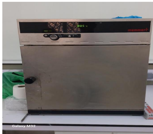
Figure II.2. Photo de l'étuve de séchage utilisée au laboratoire.
