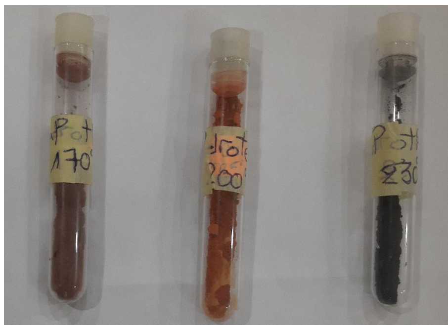
Figure III.2. Poudre de composés \text{Cu}_2\text{WS}_4 synthétisé par la méthode Hydrothermale.
