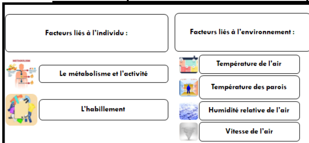
Figure 5 : Les facteurs du confort thermique. Source: architecture et confort thermique dans les zones arides
